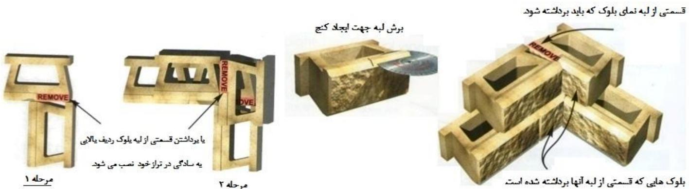
۵ - اجرا گوشه های ۹۰ درجه بیرونی: در این حالت فقط کافی است با استفاده از قطعات بتی کرنر چپ و کرنر راست دیوار با گوشه
