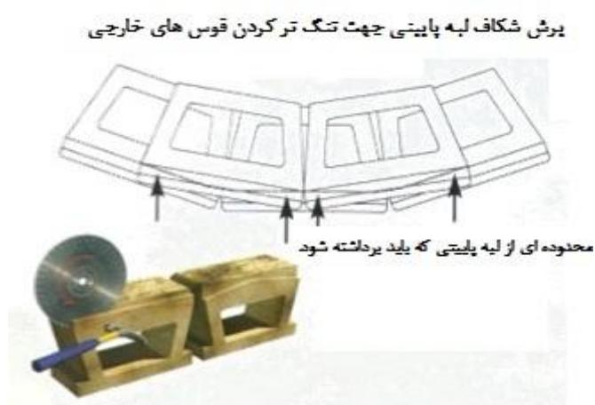
۴ - اجرا گوشه های ۹۰ درجه دروی: در این حالت فقط کافی است قسمتی از لبه یک بلوک در هر رگ بریده شود.
