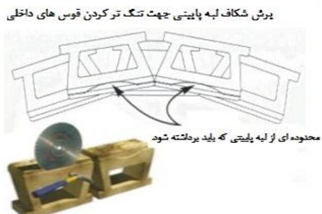
فقط کافی است که بلوکها در سطح نما به یکدیگر چسبیده باشند و فاصله بین بلوک ها در پشت دیوار ثابت بماند.
