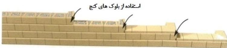
چنانچه دیوار در مسیر شیبدار واقع شود بایستی بصورت پلکانی اجرا شود که با اسفالده از قطعه کرنر با دربوش بتی بر روی آن انجام می پذیرد.
